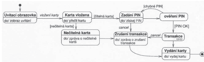
Obrázek 53 Stavový diagram pro bankomat
