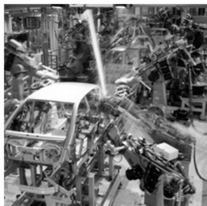
Kuka robot arms welding a Mercedes
