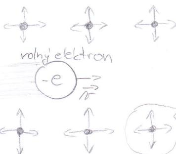
Volní elektrony se uvedou do polohy, vložíme-li latku do vnitřního el. pole o intenzitě  $\vec{E}$ . Na elektron s nařízením  $(-e)$  pak působí síla:
