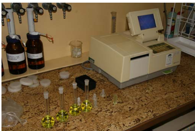
Vybavení chemické laboratoře. Spektrometr – určí chemické složení látky z barvy roztoku.
